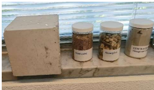
Figuur 34; Samenstelling beton. (Loonen, 2024)
